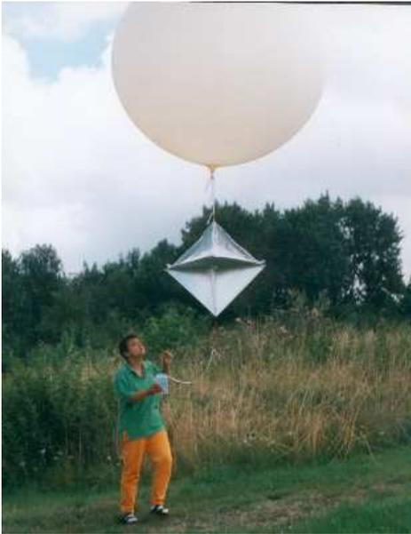
**Abb. 1 (links):** An circa 550 Stationen werden weltweit täglich zwei Mal **Radiosonden** (= Sondierung der Atmosphäre mittels einer Ballon-Sonde) gestartet. Bei bekannter Aufstiegs-geschwindigkeit kann die Höhe bestimmt und mit Messfühlern Temperatur, Druck und Feuchtigkeit gemessen und zugeordnet werden. Mit Radar wird die Sonde geortet, und daraus wird Windrichtung und Windgeschwindigkeit bestimmt. (Foto: K. Wehry)
